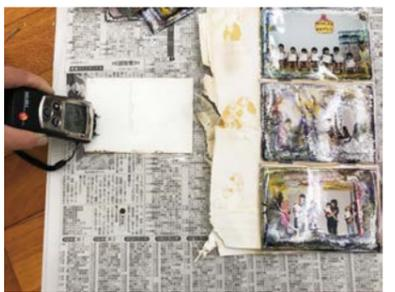
被災写真の含水量測定
