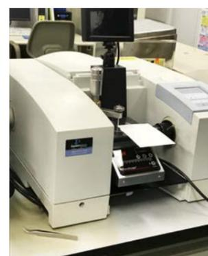
図2 図1の表面分析に用いたフーリエ変換赤外吸収分光分析装置 (FTIR)
